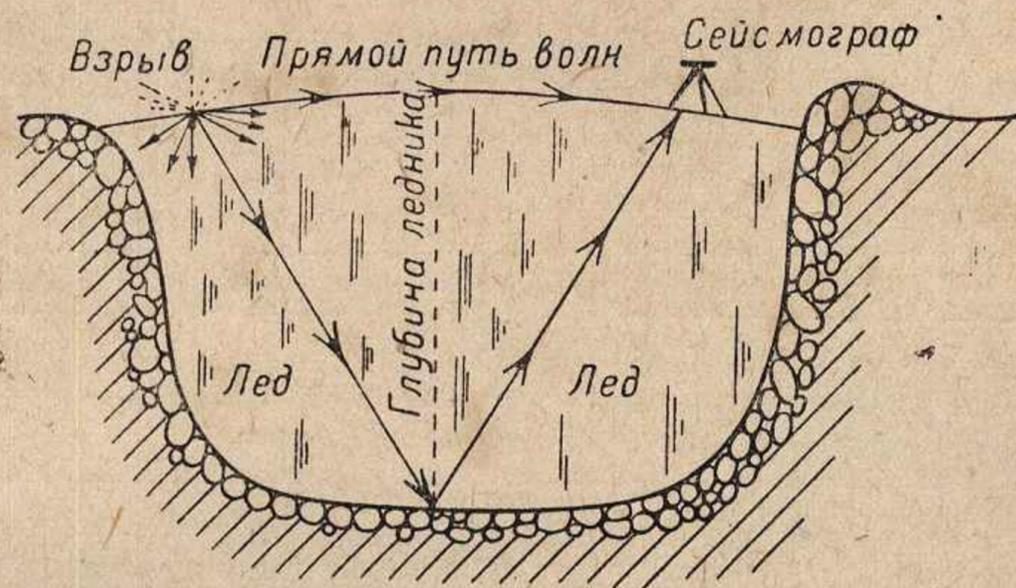
Схема зондирования гренландского ледника взрывными волнами
